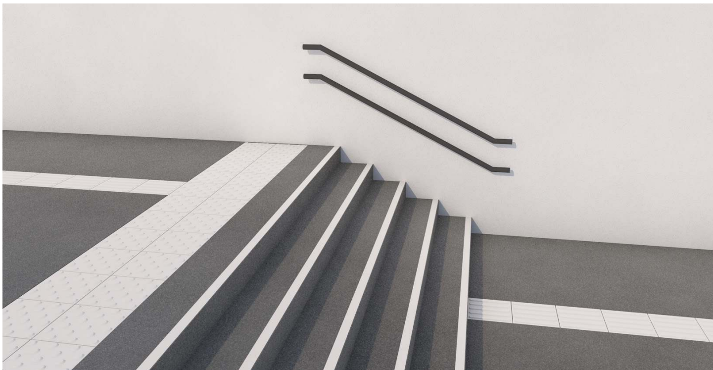
2. ábra: példa veszélyre figyelmeztető taktilis jelzés helyes kialakítására lépcsőnél
